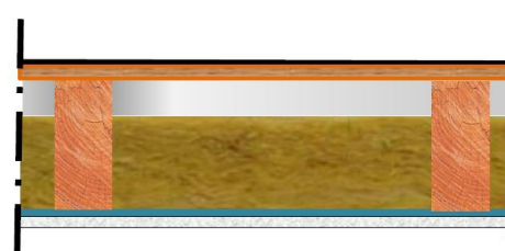
Uventileret paralleltag med tagpap. Over isoleringen kan der være et uventileret hulrum. I nyere konstruktioner vil hulrummet ofte være udfyldt.
