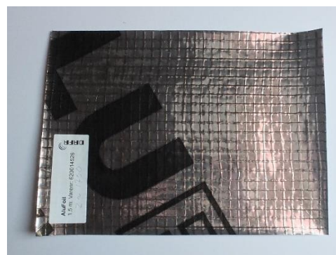
Aluminiumsbaseret dampspærre. Denne type er armeret med et net af plastiktråde. Foto: Jan H. C.
