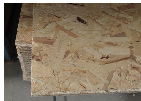
OSB-plader. De kan i den rigtige kvalitet (EGGER OSB 4 TOP eller lig- nede kvalitet) anvendes som damp- spærre ved papir eller træuldsisole- ring. Anvendes ofte i bæredygtigt byggeri. Foto: Jan H. C.
