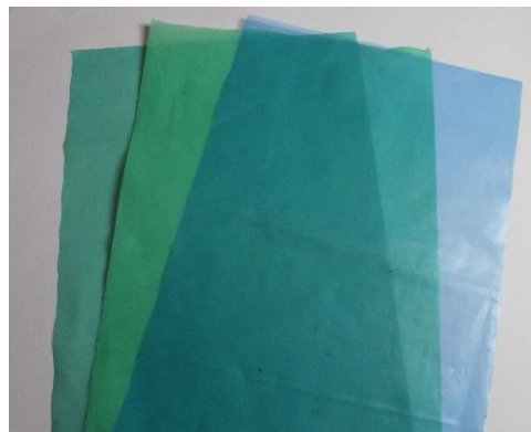
Eksempler på dampspærre af PolyEthylen (PE-folie). Foto: Jan H. C.
