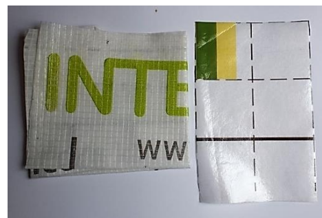
Eksempler på fugtadaptiv dampspærre. Intello til venstre og Vario til højre. Foto: Jan H. c.
