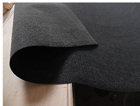
Bitumenbaseret dampspærre/ tagpap. Foto: Jan H. C.
